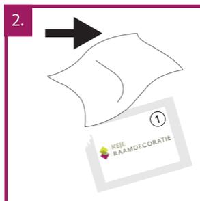
Als erstes öffnen Sie den Beutel mit der Nummer 1. Mit dem Tuch entfetten und reinigen Sie die Oberfläche, auf der das Stahlband später geklebt wird. Es ist wichtig, in eine Richtung zu säubern. Gehen Sie also NICHT auf das Fenster auf und ab. Lassen Sie den Rahmen gründlich trocknen, bevor Sie Beutel 2 nehmen.
