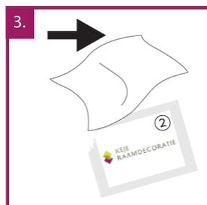
Wanneer het kozijn goed droog is, kunt u zakje 2 open maken en gebruiken. Deze doek zorgt voor de primerlaag op het kozijn. Belangrijk is om **één** kant op te strijken. Ga dus NIET op en neer over het kozijn heen.
