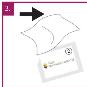
Wenn das Fenster vollständig trocken ist, können Sie Beutel 2 öffnen und verwenden. Dieses Tuch bildet die Grundierungsschicht auf dem Rahmen. Es ist wichtig, in eine Richtung zu säubern. Gehen Sie also NICHT auf das Fenster auf und ab.
